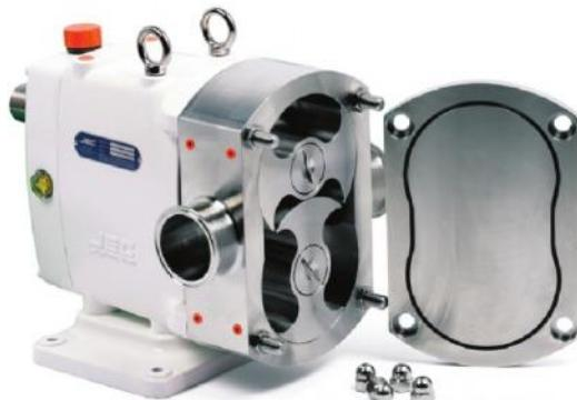
В насосе практически отсутствуют изнашиваемые части, он рассчитан на постоянную работу, конструкция позволяет проводить обработку насоса огнем, температурой до 130°C, что важно в пищевой и фармацевтической промышленности.
